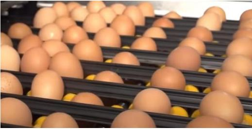
La esencia del transportador son las varillas galvanizadas o plastificadas paralelas entre sí, ensambladas por placas troqueladas de chapa en las orillas o cadenas laterales de arrastre.
