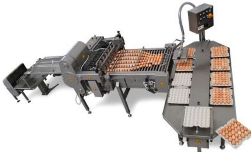
El diseño neumático de la cascadora garantiza que cada huevo se mantenga en su lugar con la misma presión exacta. La máquina tiene una cantidad mínima de piezas móviles, mientras que todas las piezas esenciales operan en un baño de aceite protector y, por tanto, sólo requieren un mantenimiento mínimo.
