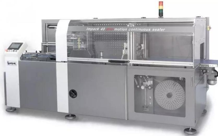
Máquina de operación ininterrumpida con sistema de movimiento continuo, sellado cruzado accionado por servomotor de doble eje, alta precisión y consistencia con sellado transversal y lateral, embalaje sin límite de longitud.
