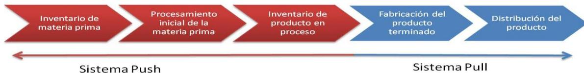
Figura 2. Sistema híbrido Push-Pull
