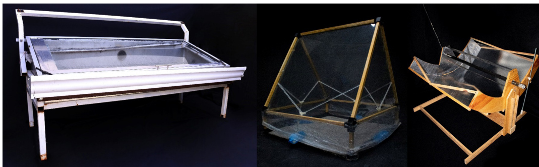
Fig. 2. Prototipos de desalinizadores solares realizados en UFG, El Salvador. Izquierda: Modelo clásico; basado en la literatura clásica del proceso de destilación. Centro: Modelo flotante; diseño de bajo costo para ser implementado directamente sobre la superficie de agua. Derecha: Modelo parabólico con alta concentración de luz para mejorar la eficiencia térmica del proceso de desalinización, que produce hasta 8 litros de agua desalinizada por día y metro cuadrado de superficie irradiada.
